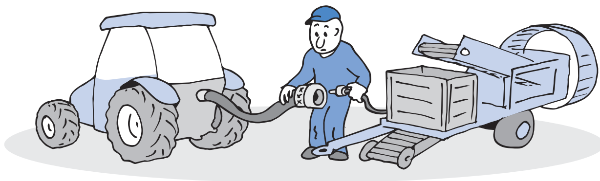
Bild 4. Det är viktigt att traktor och redskap är anpassade till varandra. Man kan till exempel ibland behöva koppla in en extra hydraulisk signalledning mellan traktor och redskap för att de ska fungera effektivt ihop.
