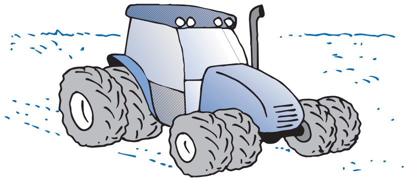
Bild 6. Det anses vara möjligt att spara 2-4% bränsle genom att använda breda däck i fält, beroende på att hjulen då inte sjunker ner i marken.
