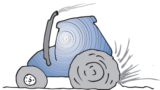
Bild 7. Med låsta differentialspärrar kan man minska slirningen, och även förlusterna i växellådan.
